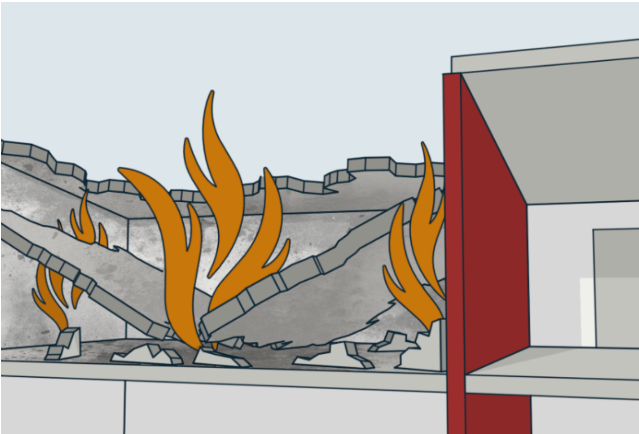
§ 11-6 Figur 4: Brannveggen må være stabil i den forutsatte brannmotstandstiden selv om byggverket faller sammen på en side. Alternativ med tak som har brannmotstand minst EI 60 A2-s1, d0 [A 60].
