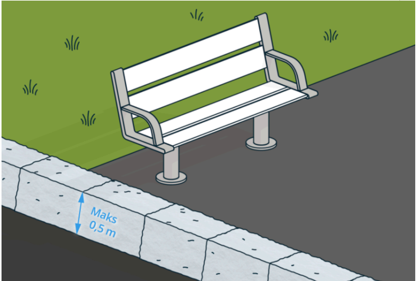
§ 8-3 Figur 1: Eksempel på nivåforskjell som er tydelig merket visuelt og taktilt.
